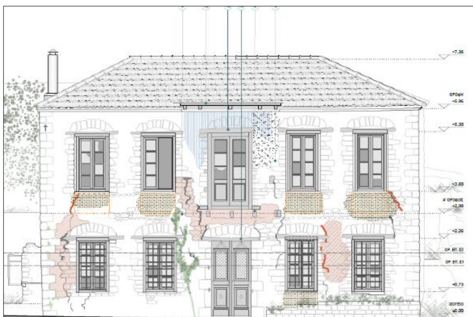
Εικόνα 3-51. Οικία Νικόπουλου. Ανατολικός εγκάρσιος τοίχος με ρωγμές λόγω εκτός επιπέδου κάμψης. Πηγή: Ερευνητική ομάδα ΕΜΠ, 2023. Σχέδια: Ε. Θεοδωράκογλου, Β. Μαντέλου, Ε. Φλώρου, Ν. Χούμα, μεταπτυχιακές φοιτήτριες ΔΠΜΣ «Προστασία Μνημείων» ΕΜΠ.
