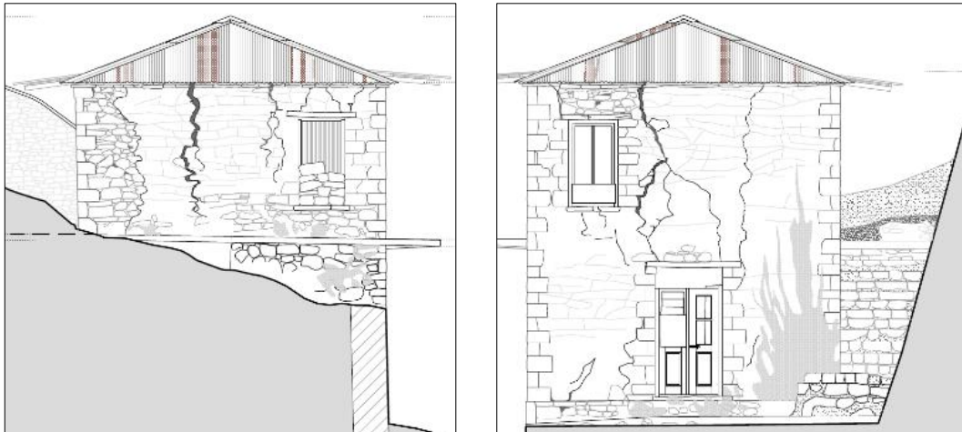
Εικόνα 3-52 και Εικόνα 3-53. Παλαιό Καφενείο. Ρωγμές λόγω κάμψης εκτός επιπέδου στους εγκάρσιους τοίχους (αριστερά και δεξιά αντίστοιχα). Πηγή: Ερευνητική ομάδα ΕΜΠ, 2023. Σχέδια: Κ. Καραγιαννακίδου, Ν. Κρεκούκια, Μ. Μέρου, μεταπτυχιακές φοιτήτριες ΔΠΜΣ «Προστασία Μνημείων» ΕΜΠ.
