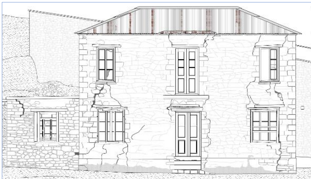
Εικόνα 3-54. Παλαιό Καφενείο. Ρωγμές λόγω διάτμησης και εντός επιπέδου κάμψης στον διαμήκη τοίχο. Πηγή: Ερευνητική ομάδα ΕΜΠ, 2023. Σχέδια: Κ. Καραγιαννακίδου, Ν. Κρεκούκια, Μ. Μέρου, μεταπτυχιακές φοιτήτριες ΔΠΜΣ «Προστασία Μνημείων» ΕΜΠ.
