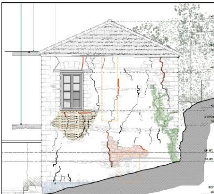
Εικόνα 3-50. Οικία Νικόπουλου. Νότιος διαμήκης τοίχος με ρωγμές λόγω διάτμησης και εντός επιπέδου κάμψης. Πηγή: Ερευνητική ομάδα ΕΜΠ, 2023. Σχέδια: Ε. Θεοδωράκογλου, Β. Μαντέλου, Ε. Φλώρου, Ν. Χούμα, μεταπτυχιακές φοιτήτριες ΔΠΜΣ «Προστασία Μνημείων» ΕΜΠ.
