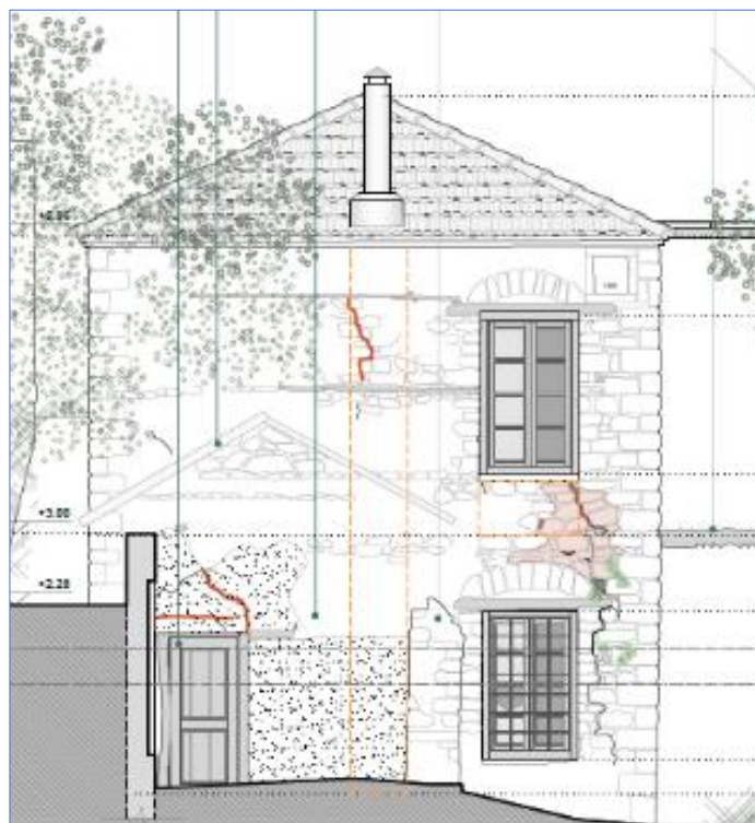
Εικόνα 3-49. Οικία Νικόπουλου. Εγκάρσιος Δυτικός τοίχος με ρωγμές λόγω εκτός επιπέδου κάμψης. Πηγή: Ερευνητική ομάδα ΕΜΠ, 2023. Σχέδια: Ε. Θεοδωράκογλου, Β. Μαντέλου, Ε. Φλώρου, Ν. Χούμα, μεταπτυχιακές φοιτήτριες ΔΠΜΣ «Προστασία Μνημείων» ΕΜΠ.
